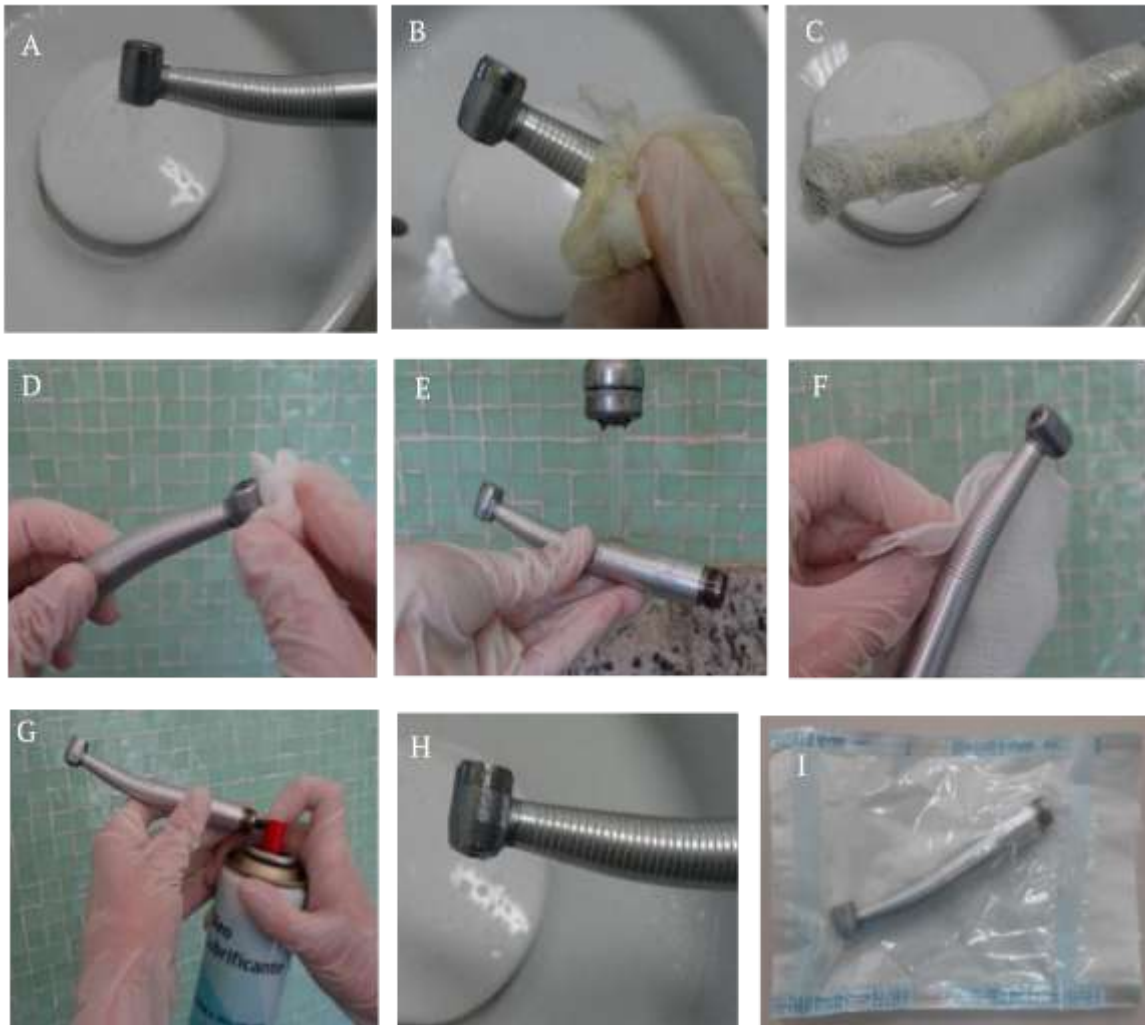
Figura 7: Sequência de limpeza dos motores odontológicos: A) Acionar por 30 segundos as linhas de ar/água das canetas de alta-rotação; B) Envolver o motor com uma gaze encharcada com detergente enzimático por 4 minutos (tempo preconizado pelo fabricante); C) Friccionar a gaze encharcada com detergente enzimático por todo o corpo da caneta por 30 segundos; D) Lavar a cabeça da caneta com uma gaze encharcada com água; E) Imersão do corpo do motor em água corrente para remoção do detergente enzimático; F) Secar a caneta com gaze; G) Aplicar o lubrificante; H) remover o excesso de lubrificante por meio do acionamento da caneta por 20 segundos, tendo as linhas de água fechadas; I) Embalar a caneta em papel grau cirúrgico.
