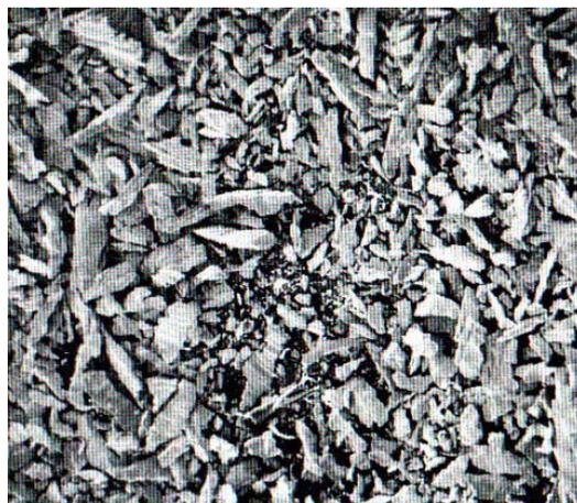
Figura 2. Fotomicrografia das partículas de limalha.
