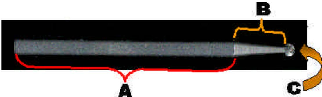
Figura 3.15. Partes constituintes das fresas: haste (A); intermediário (B); ponta ativa (C).
