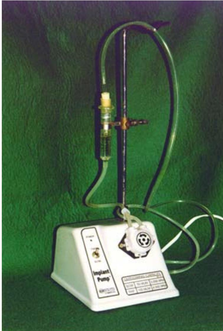
Figura 1. Dispositivo montado para os testes de dissolução, acoplado à bomba peristáltica.
